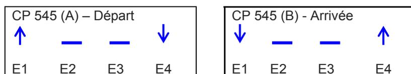
Le statut des entrées doit être programmé spécifiquement lorsque plusieurs CP 545 doivent communiquer entre eux par la liaison RS 232 ou avec Docking GSM. Ainsi, chaque appareil sera capable de recevoir les informations enregistrées au départ et à l'arrivée.
